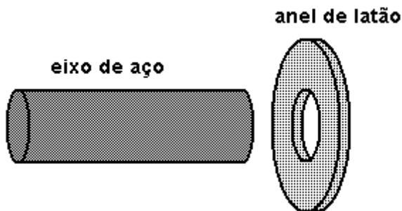
À temperatura ambiente, o diâmetro do eixo é maior que o do orifício do anel.
